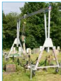
Fig.3 Exemple d'application, portique avec roues pneumatiques et stabilisateurs.
