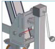
Fig.2 Stabilisateurs sécurisés avec goupilles et clips.
