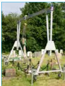
Fig.3 Sistema Wind Up Jack Leg in posizione - normalmente usato con ruote pneumatiche per tutti i terreni "All Terrain Castors".
