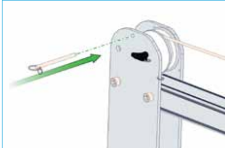
19. Sichern sie den Draht /das Seil mit dem mitgelieferten Einschub-Pin
