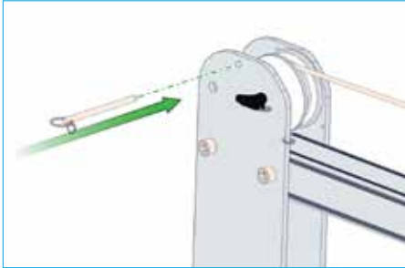
19. Sécuriser le câble /la corde du treuil à l'aide de la goupille de retenue fournie
