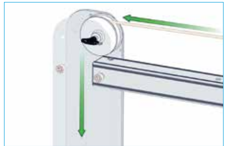
18. Faire passer le câble/la corde du treuil autour de la poulie
