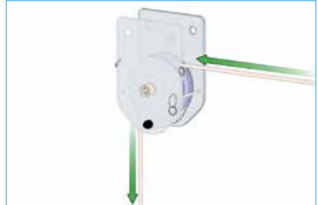
20. Faire passer le câble/la corde autour de la poulie du chariot poulie
